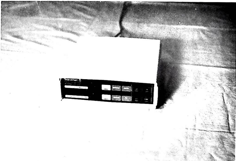
Figur 4 visar ett 75/1200 modem och ett 1200/1200
